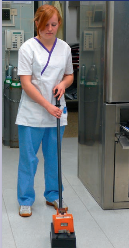
Kontaminationsüberprüfung des Bodens am Ende des Arbeitstages im Heißlabor.
