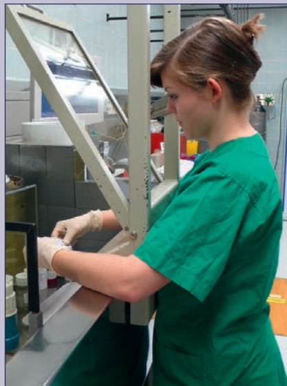
Arbeitsplatz im Heißlabor für Arbeiten mit Tc-99m. Gefahr der Kontamination der Unterarme, ein langer Kittel oder Armschoner können diese Gefahr reduzieren.
