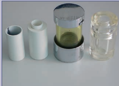
Von links nach rechts: Bleitopf 5 mm Wandstärke Bleitopf 1 cm Wandstärke Bleiglas Plexiglas für \beta^- - Strahler (Yttrium-90)
