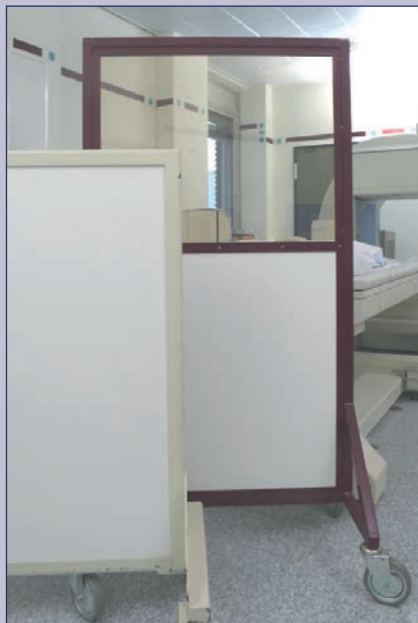
Mobile Schutzwand Für Tc-99m (hinten) Für I-131 (vorne links)
